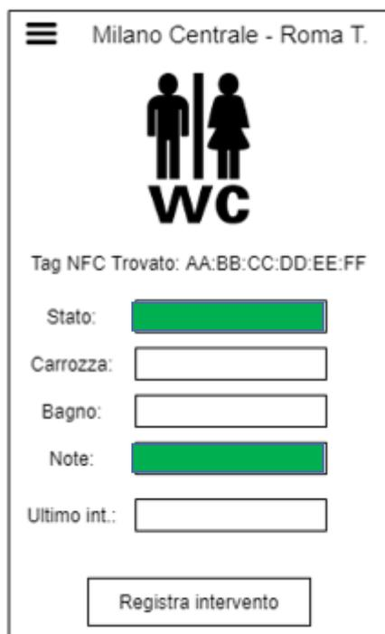
Alla lettura di ogni singolo TAG, si aprirà in automatico la seguente finestra dove possono essere compilati i soli campi evidenziati in **VERDE**.
